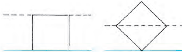
پلان برای ترسیم پرسپکتیو یک نقطه‌ای پلان برای ترسیم پرسپکتیو دو نقطه‌ای
